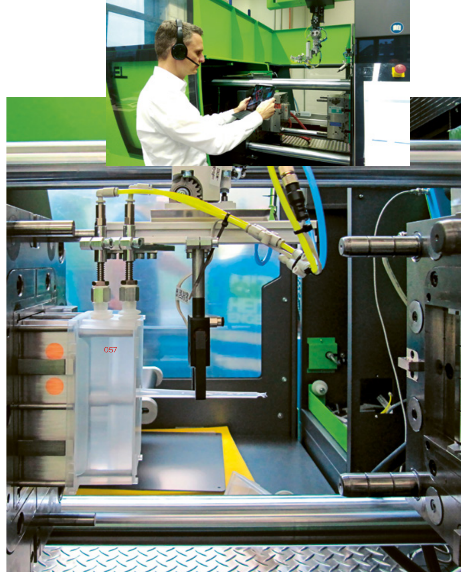
Automatisierte Herstellung eines Stapelkastens: Mittels mobiler W-Lan gestützter Tablet-Kamera blicken die Studierenden in die Spritzgießmaschine und geben Hinweise zur Anlagensteuerung.
